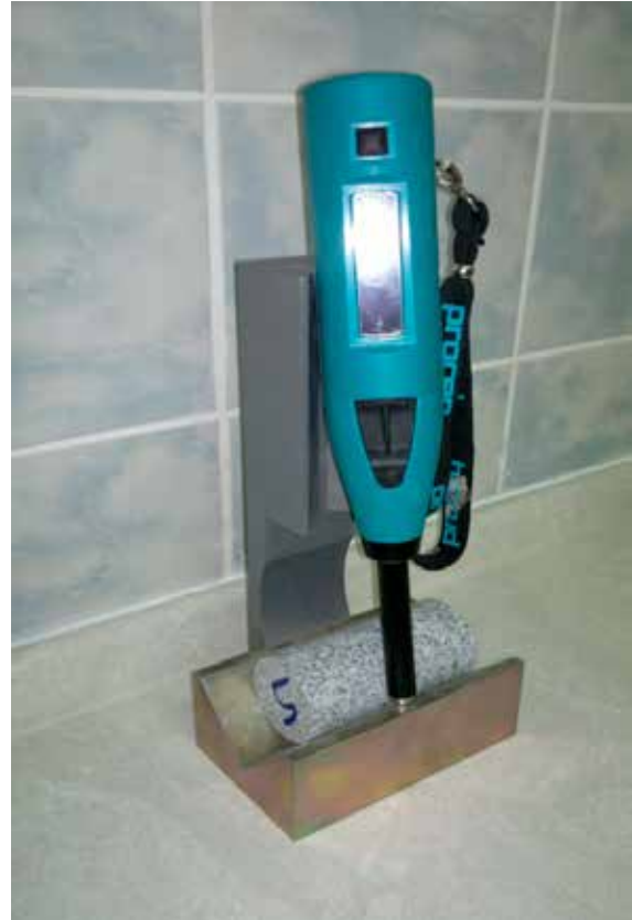
Şekil 4. Kullanılan Schmidt çekici, numune beşiği ve karot numunesi
