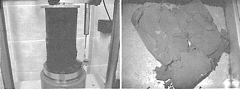
Şekil 6. %5 Cem I 42.5 içeren numunelerden birinin 360 günlük kür süresi sonrası görünümü
