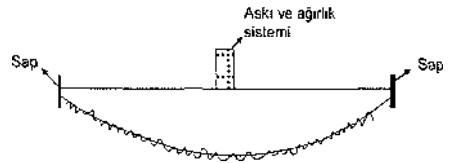
Şekil 20. Kullanılan testerenin muhtemel (tahmini) tasarımı (Kulaksız, 2008)
