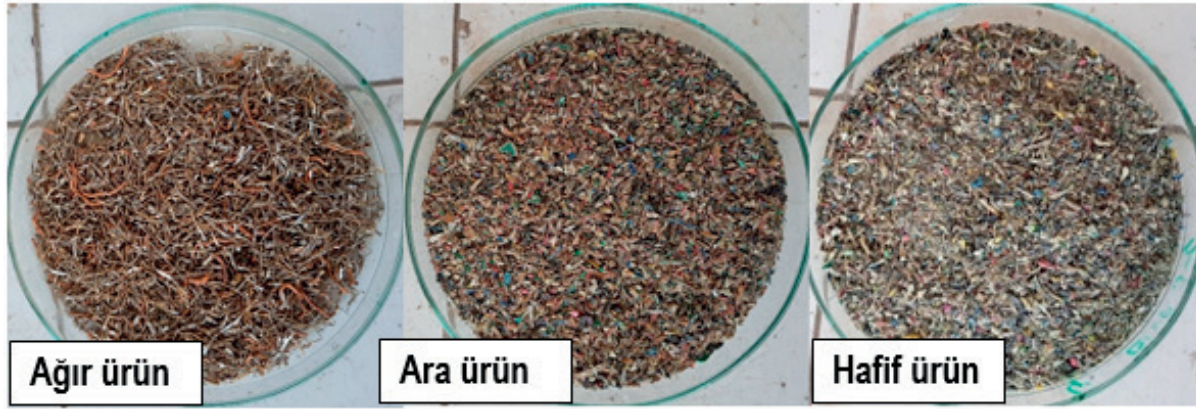
Foto 5. Zenginleştirme işlemleri sonucunda elde edilen ürünler (-2 mm metal ağırlıklı ürün)
