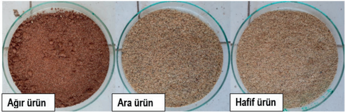
Foto 7. -0,5 mm boyut grubunda elde edilen sarsıntılı masa ürünleri
