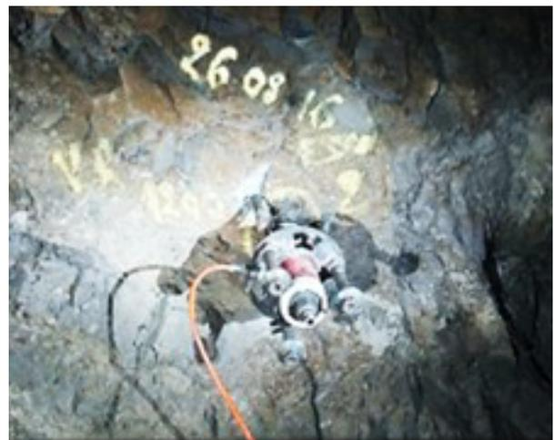
*Fig.6. Pullout test*
