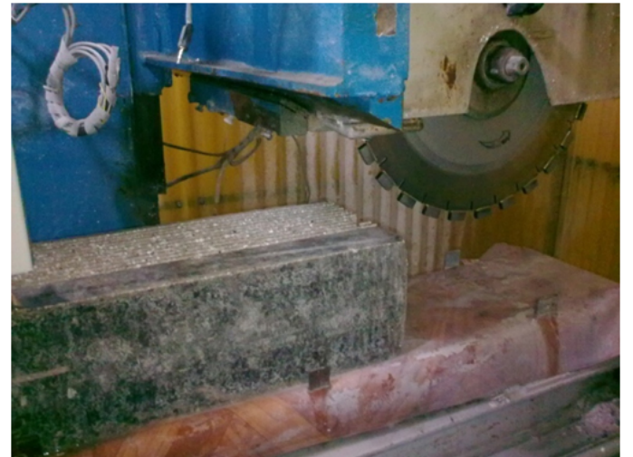
Şekil 2. Dairesel testereli kesme makinesinde beton blok numunesini genel görünümü.
