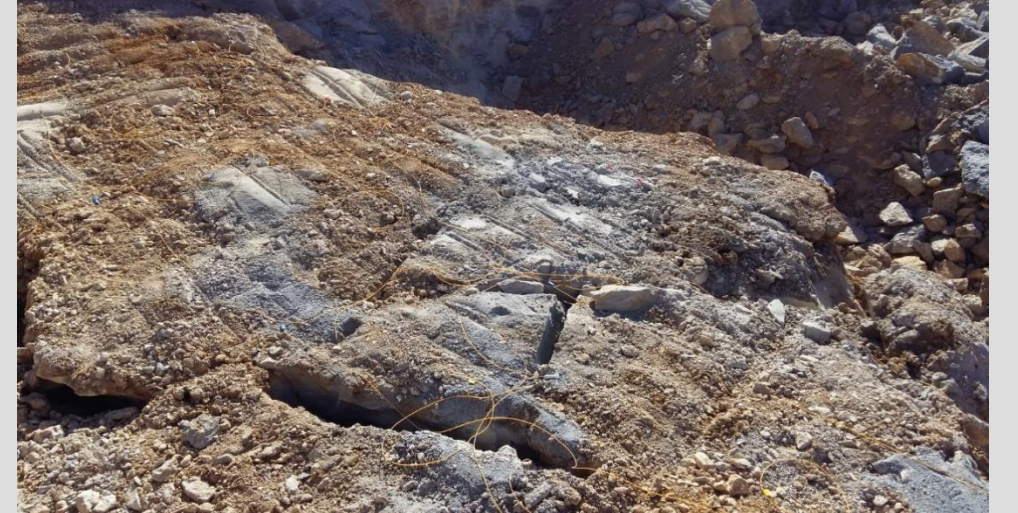
Şekil 7. Şekil 6'da verilen gevşetme amaçlı patlatma sonrası görüntü
