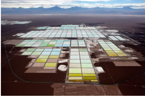
Resim 5: Salar de Atamaca Gölünde buharlaştırma havuzları
