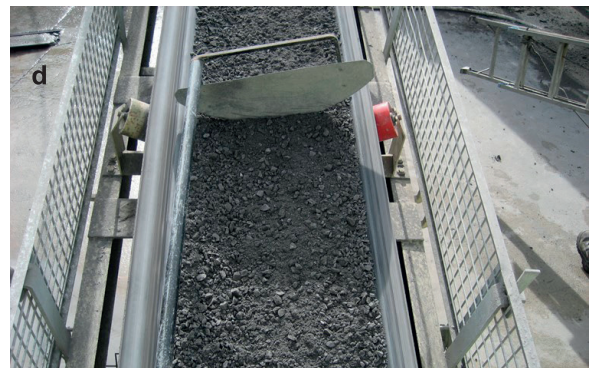
Şekil 3. a: B6150 operasyonu b: B7150 operasyonu c: kırıcı beslemesi numune alma noktası d: kırıcı ürünü numune alma noktası
