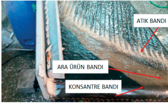
Fotoğraf 1. Sallantılı masa testine ait görüntü
