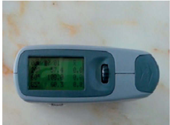
Şekil 2. Glosmetre cihazı ile ölçüm görüntüsü
