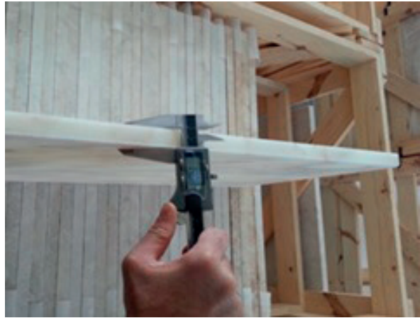
Şekil 1. Kalınlık ölçümü görüntüsü
