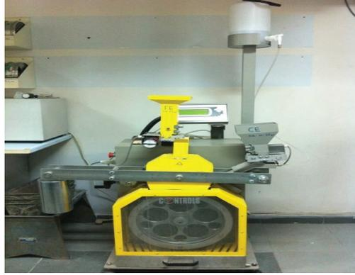
Şekil 5. Cilalanma Test Cihazı
