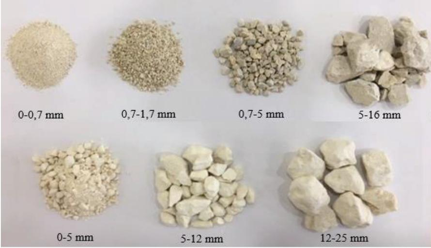
Şekil 1. Farklı boyutlardaki KT (üstte) ve UT (altta) agrega görüntüleri
