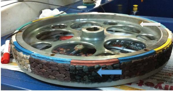
Şekil 4. Numunelerin kasnak tekerleğe yerleştirilmesi
