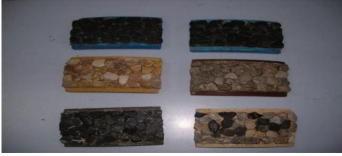
Şekil 3. Numunelerin kalıplara yerleştirilmesi
