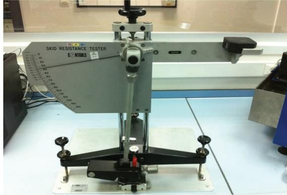
Şekil 6. Sürtünme Test Cihazı
