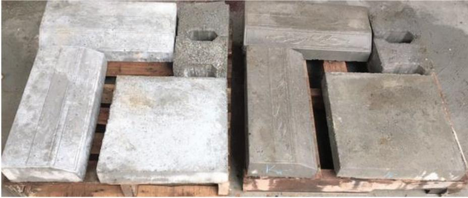
Şekil 3. Doğal agregalar ile (solda) ve yapay agregalar ile (sağda) üretilen ürün görselleri
