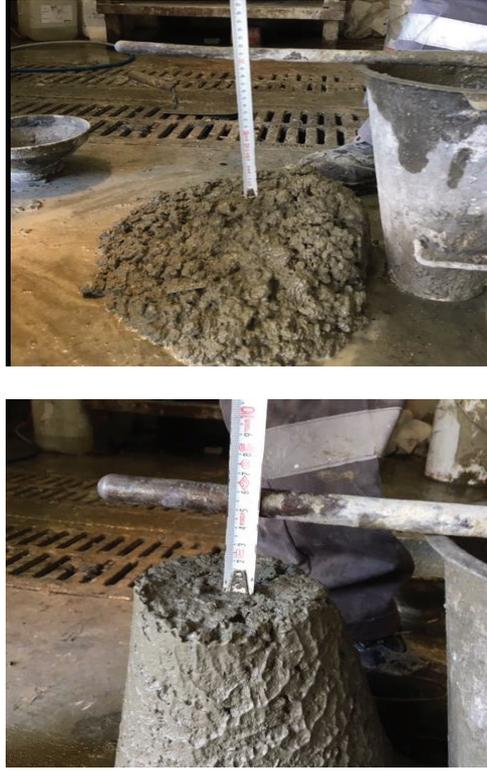
Şekil 2. Beton karışım denemeleri slump görüntüleri
