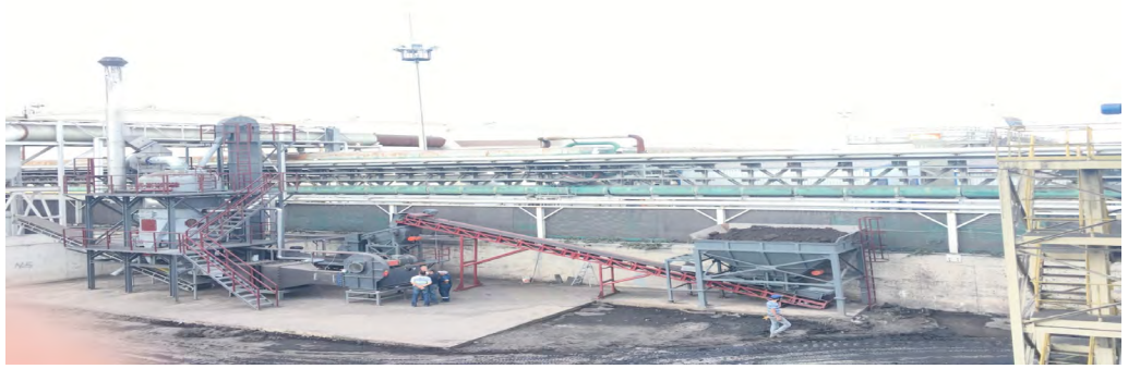
Şekil 7: Ticari Ölçekli Kömür Kurutma ve Zenginleştirme Sistemi – 10 ton/saat Kapasite
