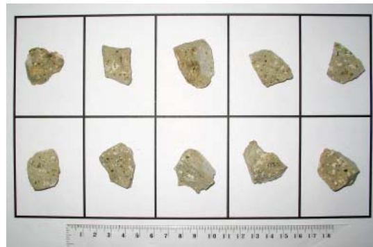
Şekil 4. Kayaç dayanım katsayısı deneyinde kullanılan örneklerin görünüşü.
