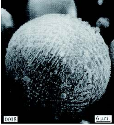
Şekil 6. Demir silikat camı ve ince Fe-spinel dendritlerinden oluşmuş FS (Vereshchagina et al., 2008)
