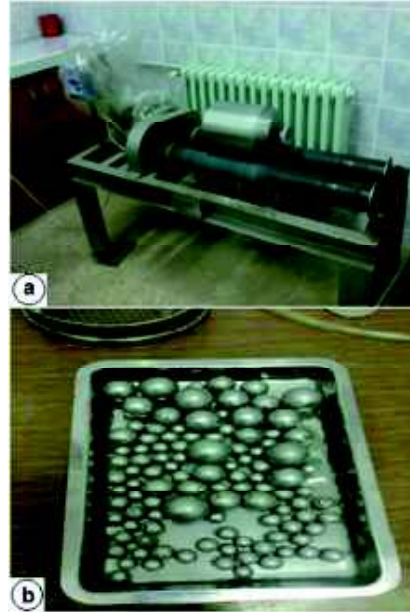
Şekil 3. Uçucu külün öğütülme işleminde kullanılan bilyeli değirmen (a) ve kullanılan bilyeler (b)
