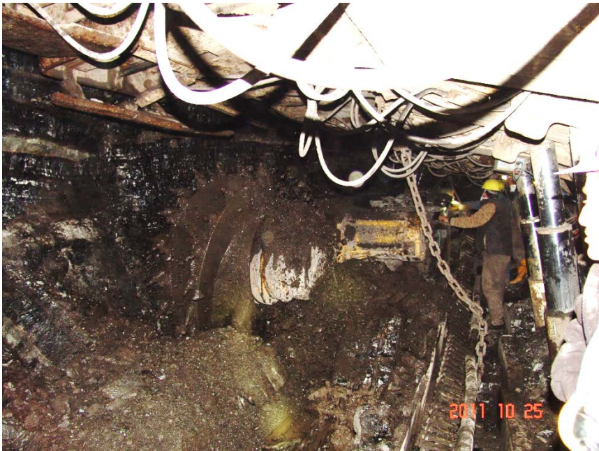
Şekil 5. Kesici yükleyici makinanın kömürü zincirli konveyöre yüklemesi
