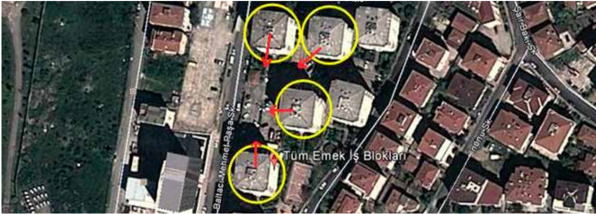
Şekil 8. Yıkım Sonucu Oluşması Planlanan Yiğın Yönleri
