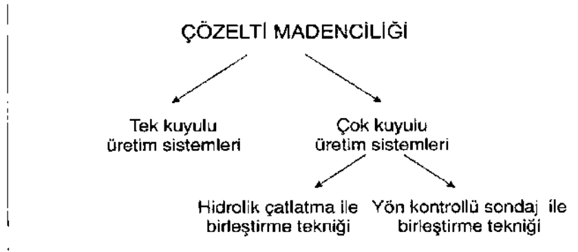
Şekil 2.4. Çözelti madenciliğinde kuyu uygulama ve birleştirme teknikleri
