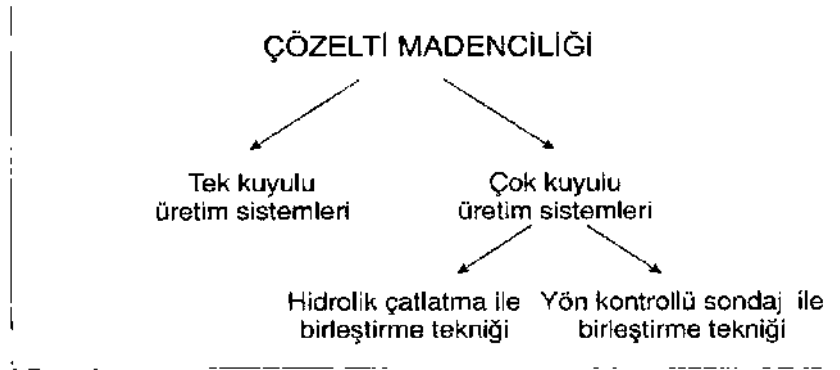
Şekil 2.4. Çözelti madenciliğinde kuyu uygulama ve birleştirme teknikleri
