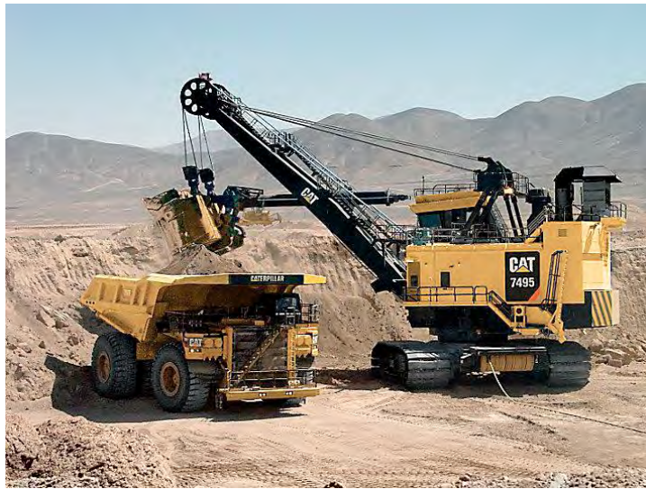
Şekil 1- ÇED Raporunda Belirtilen Kaya Kamyonu-Elektrikli Halatlı Kepçe Örneği
