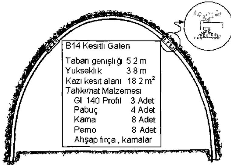
Şekil 2. B-14 kesitte uygulanan üç parçalı rijit çelik bağ
