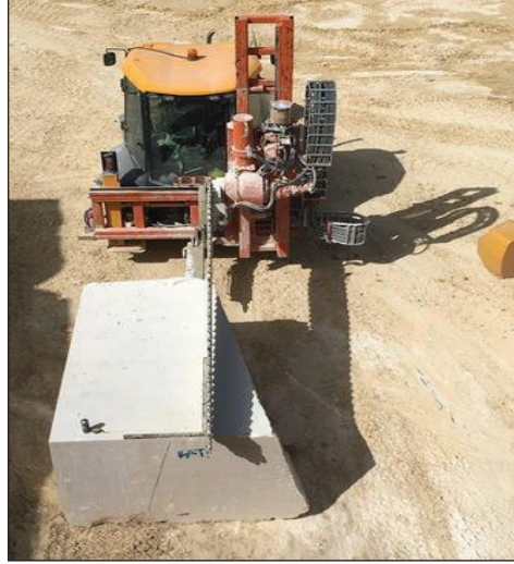
Şekil 2. Mobil Zincirli Kollu Kesici ile Ebatlama Sistemi
