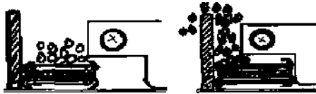
Şekil 14 Ayak döküşünün açılması ve daralması
