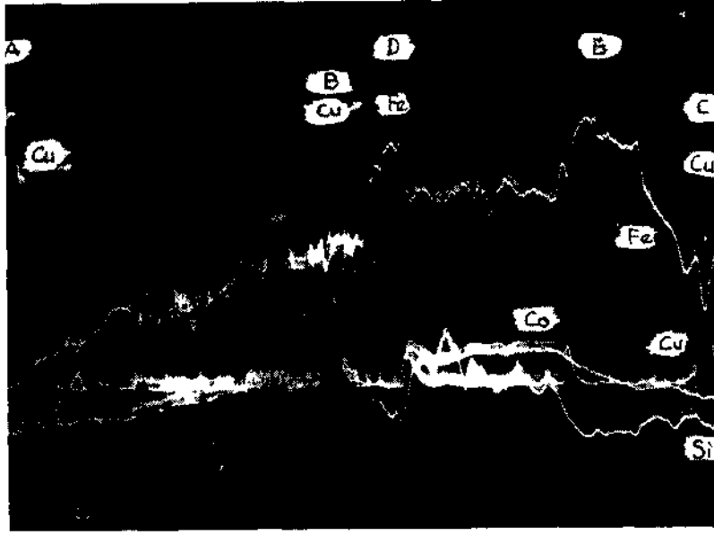
Resim 14 — Resim 13'deki çizgi doğrultusunda bakır, demir, kobalt ve silis elementlerinin dağılımları, büyütme 400x
