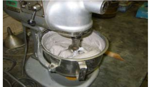
Şekil 1. PİK'in laboratuvarında karıştırılması.
