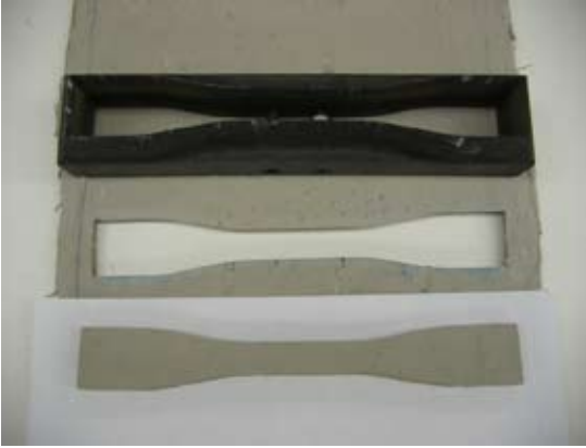
Şekil 3. PİK'in tek eksenli çekme deney örneği ve "köpek kemiği" (dogbone) kalıbı.
