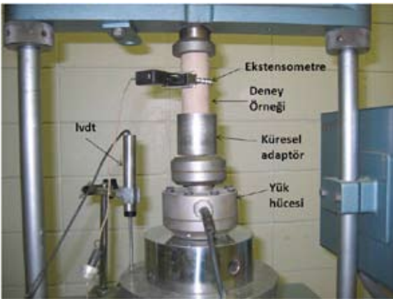
Şekil 4. Tekrarlı yükleme altındaki silindirik deney örneği.
