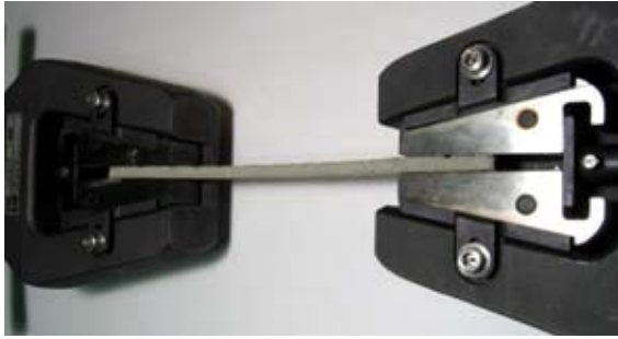
Şekil 7. Kısıpçalanmış “köpek kemiğı” PİK deney örneğı
