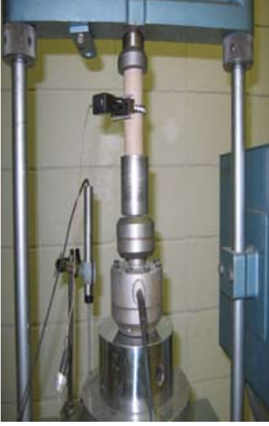
Şekil 2. PİK'in tek eksenli yükleme deney örneği.
