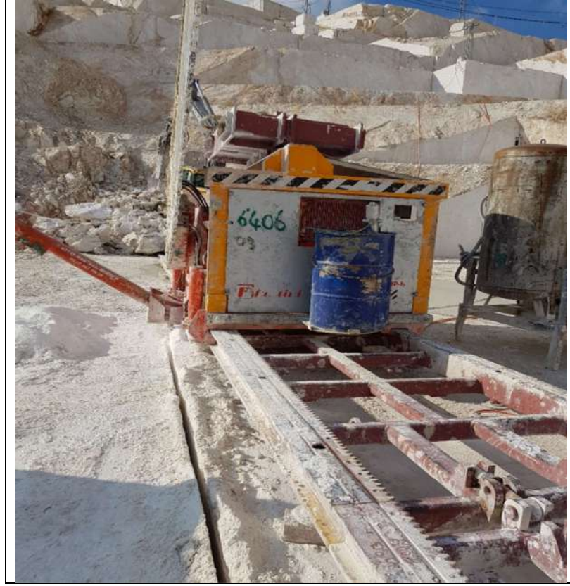
Şekil 2. Zincirli kollu kesme makinası genel görünüm
