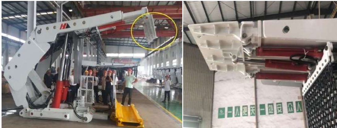
Şekil 15. Hidrolik pistonlu arın ve tavan destek üniteleri
