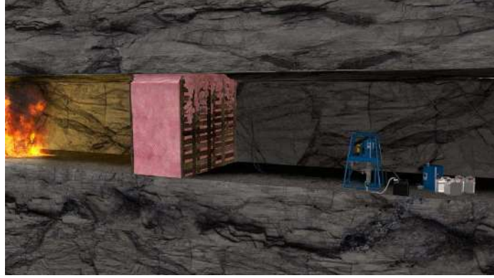
Şekil10. Yangın bölgesine köpük bariyer yapılması temsili resim(www.weber-mining.com)
