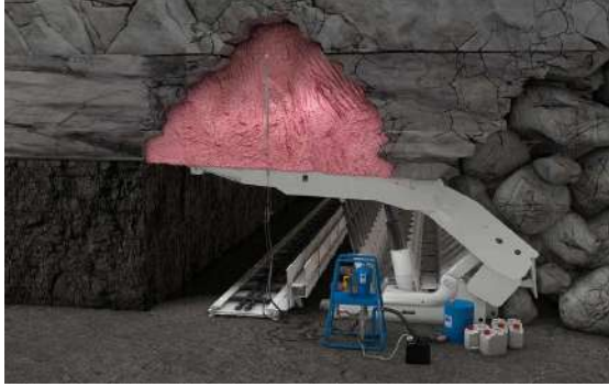
Şekil 4. Ayak içi yürüyen tahkimat üzeri boşlukların köpük ile doldurulması (Weber Kataloğu, 2019)
