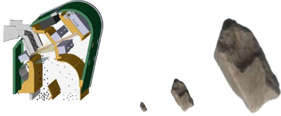
Şekil 8. Optikayıklama 2 – 120 mm (Minexx Fine < 10 mm için)
