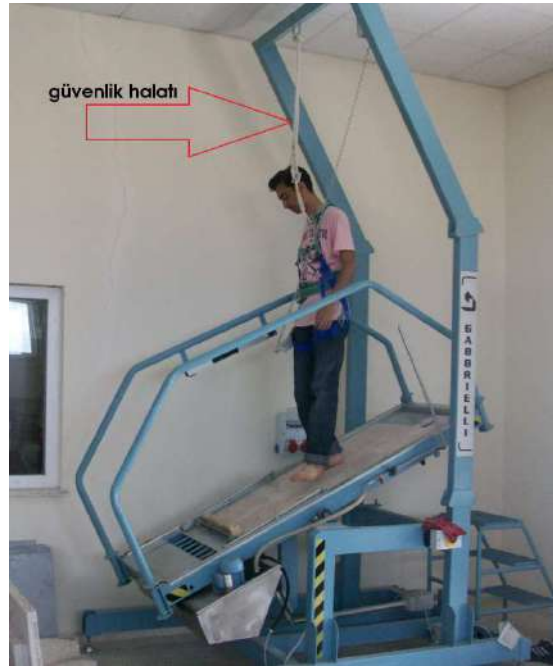
Şekil 2.Mevcut eğik düzlem test cihazı güvenlik halatı
