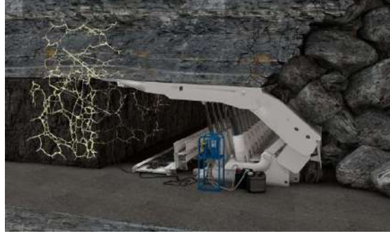
Şekil 6. Mekanize ayaklarda enjeksiyon uygulaması (Weber Katalog 2019)
