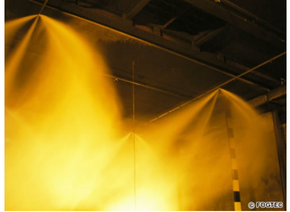
Şekil 10. Su sisi ile söndürme/bastırma (Anon(c), 2016).
