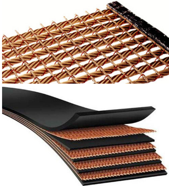
Şekil 2. Metal darbe atkılı çelik halat örgülü karkas (IWR) (üstte). Çözügüde polyester, atkıda da polyamid (nylon) iplikler kullanılan dokuma örgülü EP karkas (altta) (Anon(a), 2016)
