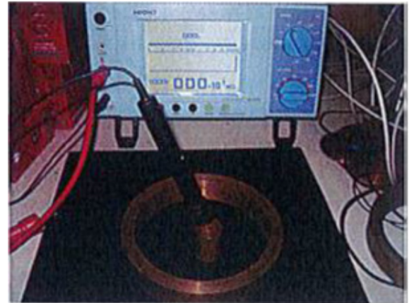
Şekil 4. Elektrik iletkenliğini belirleme deneyi (TS EN ISO 284)
