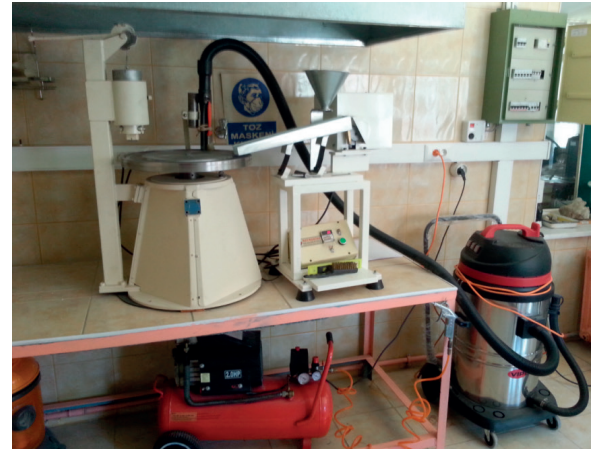
Şekil 3. Norveç aşınma indeks deneyi düzeneği
