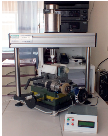
Şekil 4. West tam otomatik Cerchar aşınma indeks deney aleti
