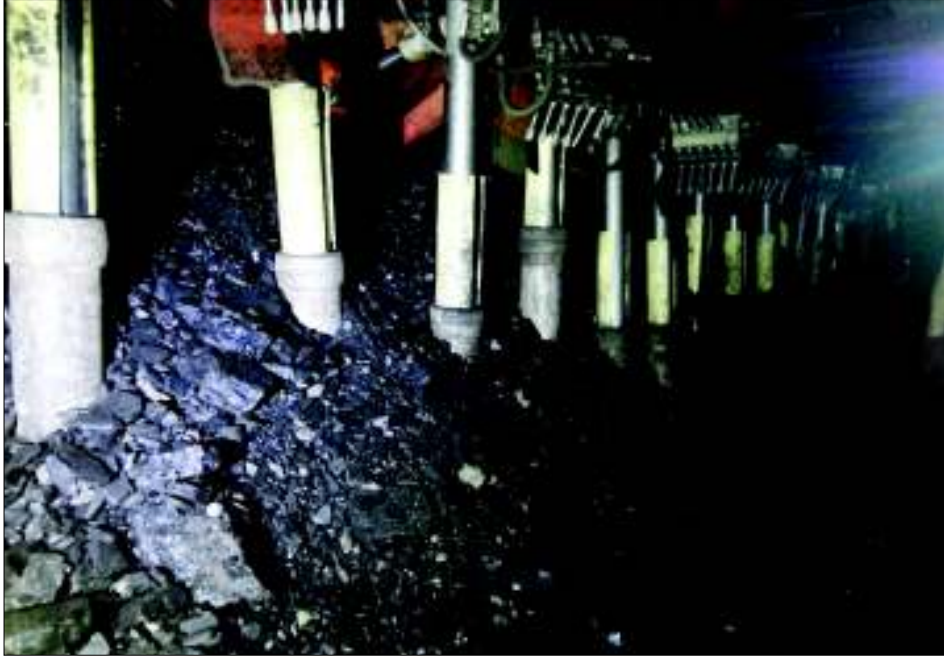
Şekil 5. Mekanize sistemde arka kömürünün alınması.
