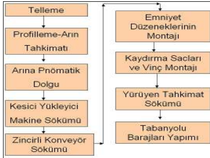
Şekil 6. Ayak ekipmanlarının söküm çalışmalarında iş akış şeması.
