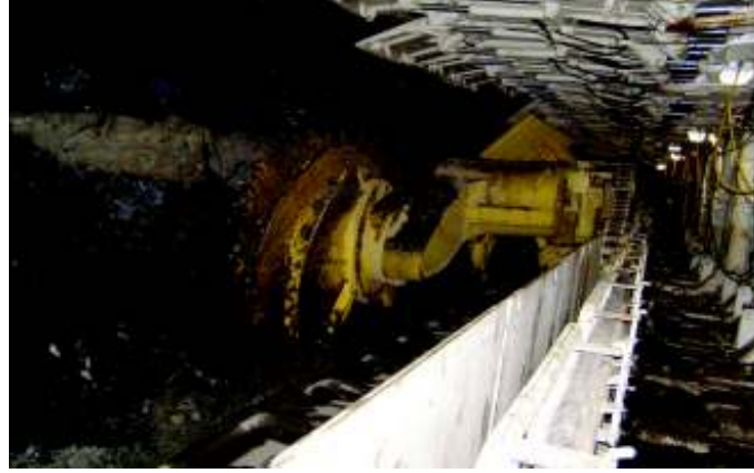
Şekil 3. Kesici yükleyici makine ile ayaktan kömür kazısı.
