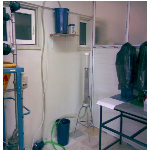
řekil 3. Kolon biyoliçi deney düzeneėi (Çukurova Üniversitesi Maden Mühendisliėi Bölümü Biyoteknoloji Laboratuvarı).
