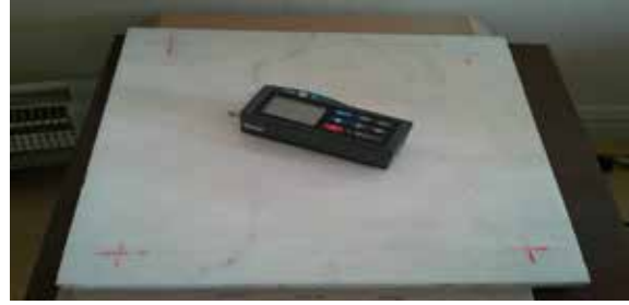
Şekil 4. Parlaklık (a) ve Pürüzlülük (b) Ölçüm Cihazları
