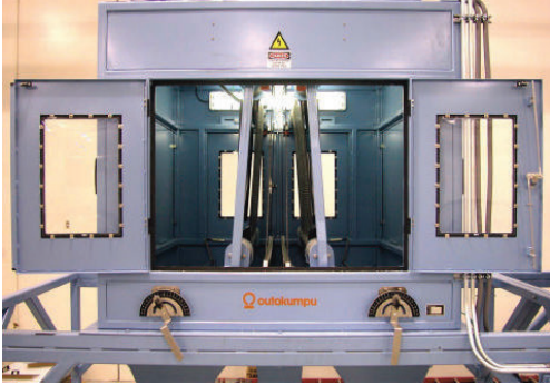
Şekil 8. Carpco T-Start model elektrostatik ayırıcısı.
