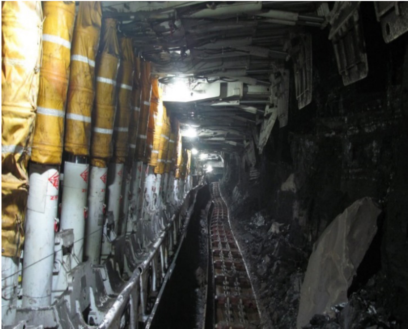
Şekil 2. Tam mekanize bir uzunayaktan görünüm (Yetkin, 2013)
