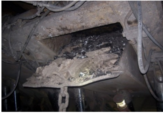
Şekil 4. Tahkimat penceresinden tavan kömürünün alınması
