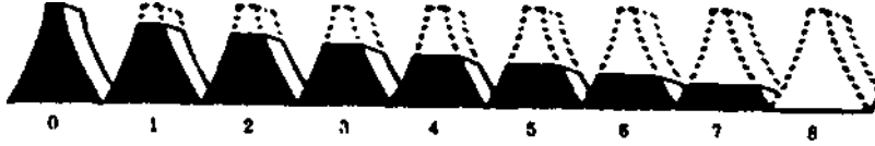
Şekil 2 Uçların Aşınma Büyüklüğüne Göre Sınıflandırılması
