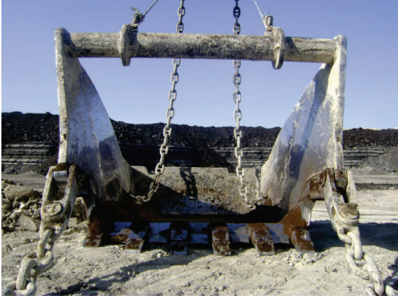
Şekil 2. Çekme kepçeli yerkazar kepçesi.
