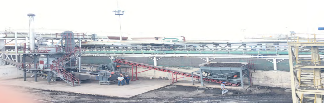
Şekil 7. Ticari Ölçekli Kömür Kurutma ve Zenginleştirme Sistemi – 10 ton/saat Kapasite
