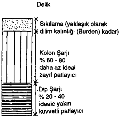
Şekil 9. Patlatma deliğinin kesiti
