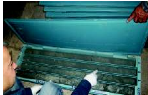
Deneyler için temsili karot numune seçimi
