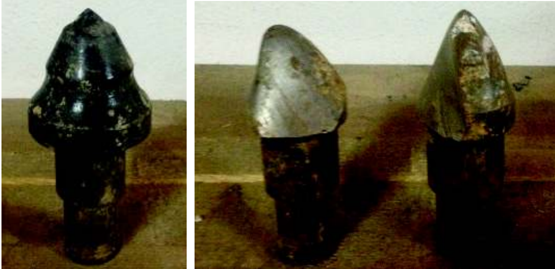
Şekil 12. Yeni (solda) ve aşınmış (sağda) keski.
