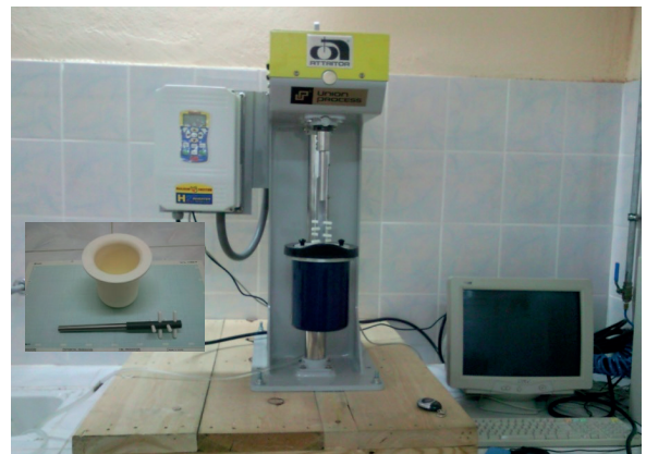
Şekil 2. Karıştırmalı değirmen, tankı ve şaftı
