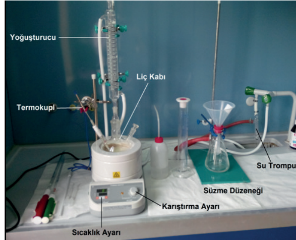
Şekil 4. Kesikli liç için kullanılan karıştırıcılı balon ısıtıcı düzeneği (solda) ve vakumlu süzme düzeneği
