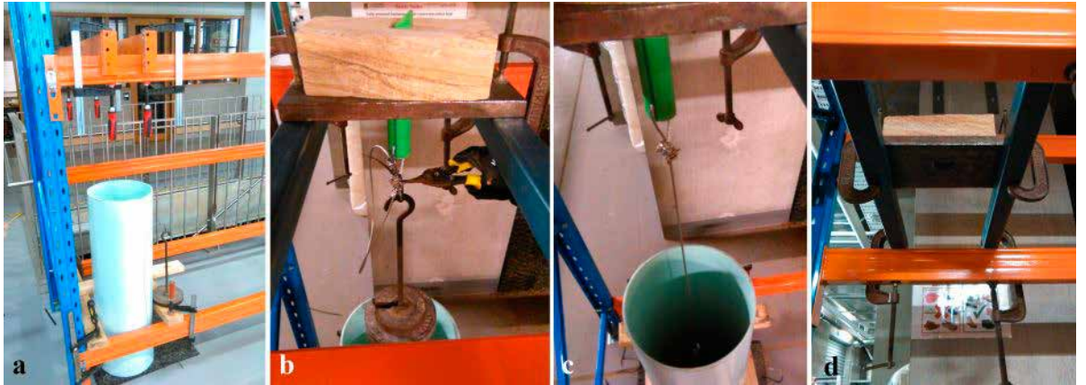
Şekil 16. a) Darbe Testi Deney Düzeneği, b) Plastik Kelepçenin Kesilmesi, c) Ağırlığın Düşmesi, d) Kaya Saplamasının Sıyrılmış Olduğu Numune
