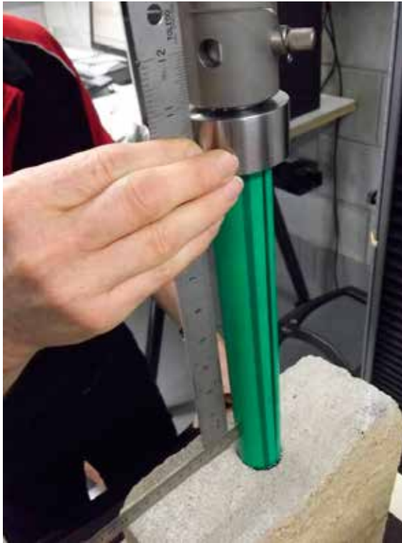
Şekil 9. Saplamanın Düşey İle Paralelliğinin Kontrol Edilmesi
