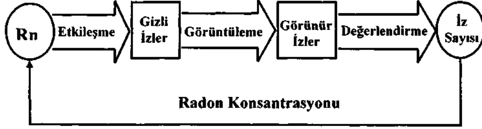
Şekil 1. Pasif radon dedektörleri ile ölçme ve değerlendirme işlemlerinin şematik gösterimi.
