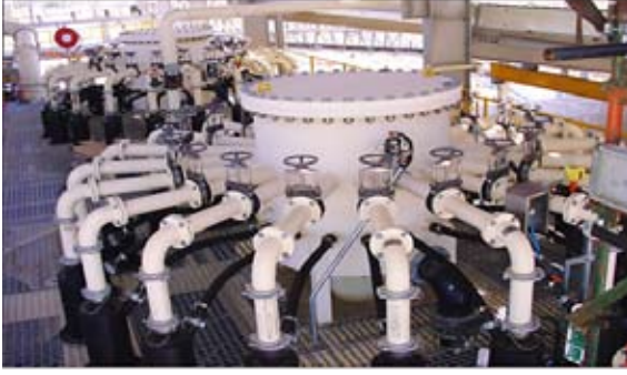
Şekil 24. Endüstriyel ölçekli Jameson flotasyon hücresi (www.jamesoncell.com)
