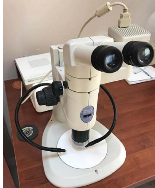
Şekil 3. Görüntü analizi de yapabilen binoküler mikroskop.
