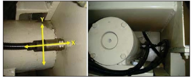
Şekil 8. Makine üzerindeki titreşim sensörleri
