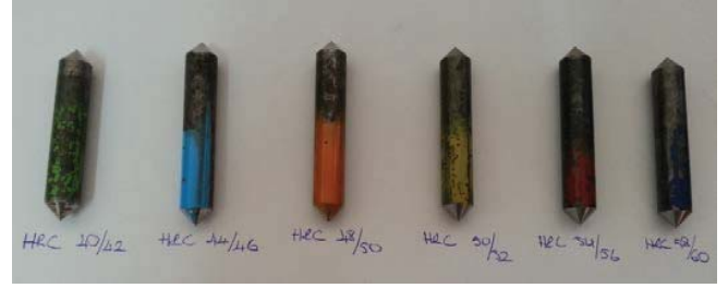
Şekil 6. CAI deneylerinde kullanılan farklı sertlikteki uçlar.
