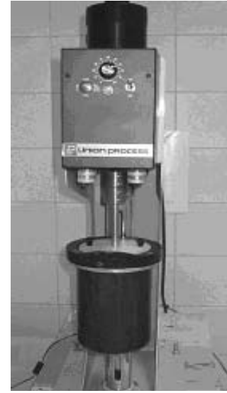
Şekil 8. Lab. tipi kırıştırmalı bilyeli değirmen (Union Process, USA) (0.7 litre).
