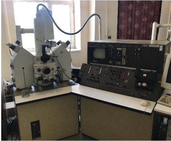
Şekil 10. Görüntülü element analizi yapabilen Mikroprop cihazı.
