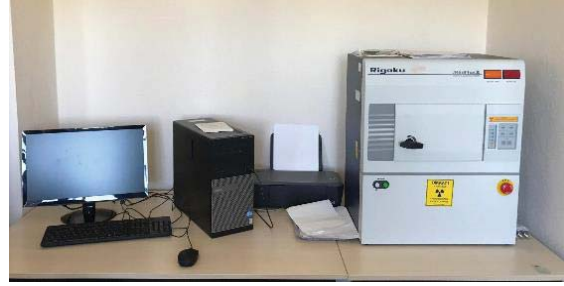
Şekil 7. Mineral analizinde kullanılan bir XRD cihazı.
