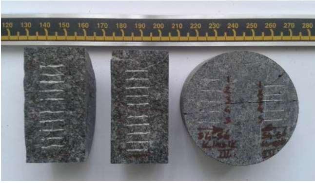
Şekil 5. CAI deneylerinde kullanılan düz yüzey ve dolaylı çekme deneyi sonrası elde edilen pürüzlü yüzeyden bir görüntü.
